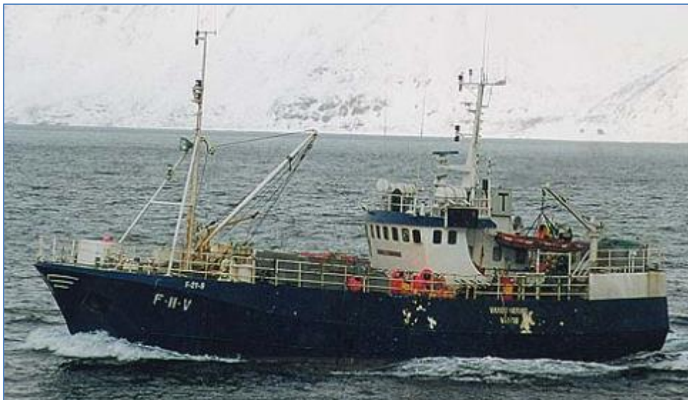
Figur 4-7. Vardøværing. LOA 27,4 m, bredde 6,7 m, dypgang 3,5 m 9
