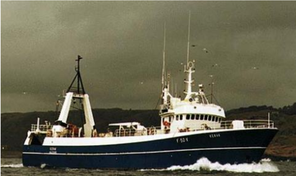
Figur 4-6. Kerak. LOA 46,5 m, bredde 9,0 m, dypgang 4,5 m. 8
