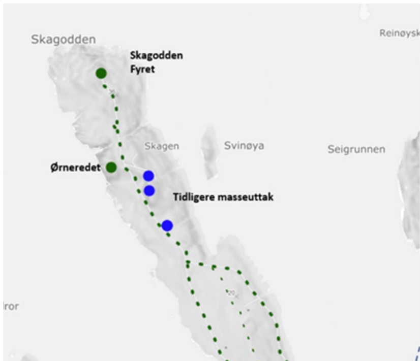
Figur 19 Blå prikker viser lokaliteter der det tidligere er tatt ut masser på Skagen. Områdene kan bli aktuelle masseuttaksområder for masse til ny ytre molo. Kilde: Vardø kommune
