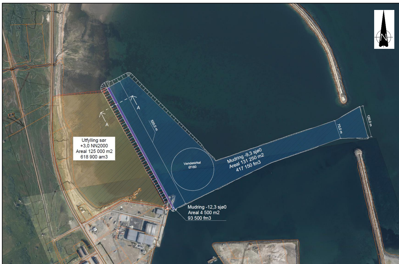
Figur 2 Oversiktstegning utfylling og utdyping [5]
