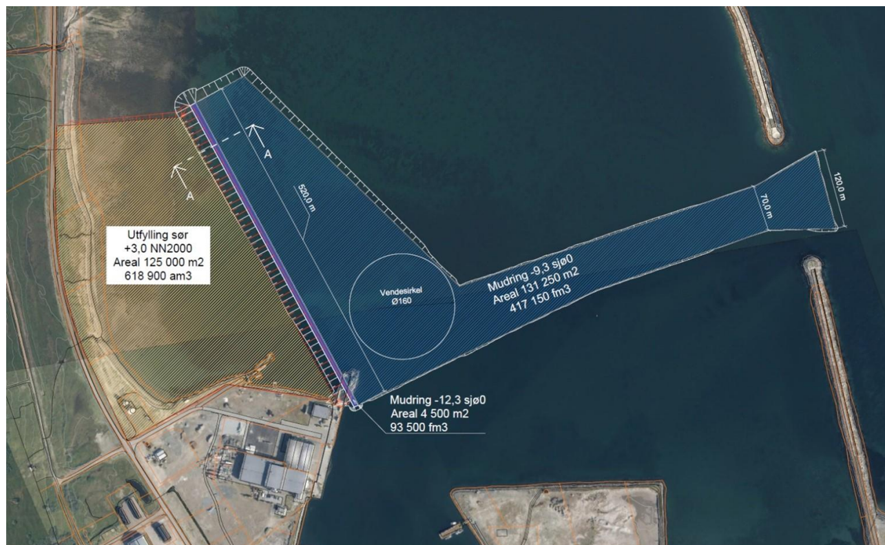
Figur 1 Oversiktstegning av planlagte tiltak i Svartnes havn. Foreløpig situasjonsplan for mudringsområde, del av utfylling på land og ny havne/kaikant. Kilde Norconsult.
